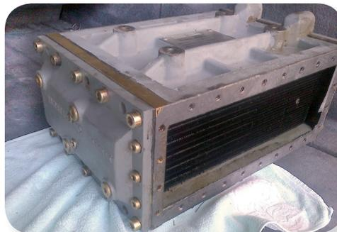
Im Anschluß ist der gereinigte Wärmetauscher wieder bereit für den Einsatz. Eine kostenintensive Neuanschaffung ist nicht erforderlich.
