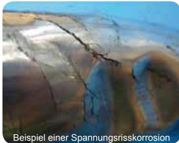
Beispiel einer Spannungsrisskorrosion
